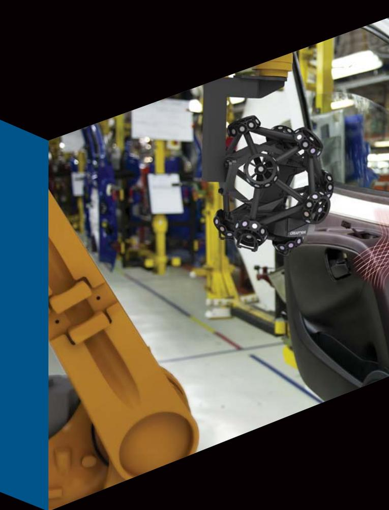
我们将质量控制与部件生产环节更紧密地结合，以加快客户的工业检测流程。针对许多公司希望快速获得精确检测结果的需求，Creaform 开发了机器人装配式光学 CMM 3D 扫描仪 MetraSCAN 3D™ R-Series。该测量系统是 Creaform MetraSCAN 3D 家族的一部分，可帮助制造企业将光学测量和工业自动化的强大优势直接运用在生产线上，使质量控制更加简单高效。MetraSCAN 3D R-Series 与工业机器人配合使用，提高了在线检测和质量控制 (QC) 流程的可靠性、速度和功能多样性。
